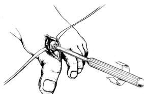
Ако използвате **имплант с дорзален фланец** вкарайте **водач за дорзална фреза** в заострения край на **конусния шифт**. Въведете **дорзалната фреза** до ограничителя за дълбочина.
